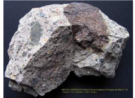
Illustration 2: era breca volcanica qu'ei un materiau de construccion tradicionau, hèra utilisath densh eth Massiu Centrau.
